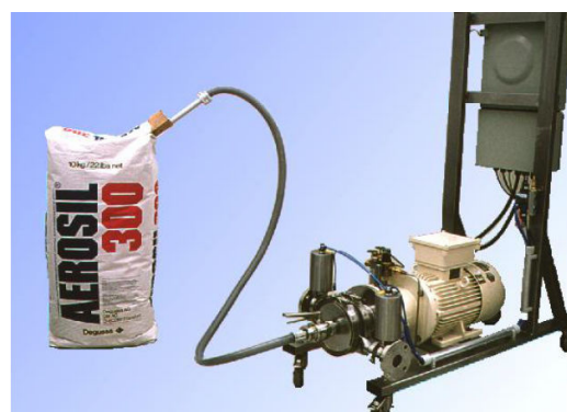
Rys. 3: ystral Conti-TDS z rurą ssącą do bezpyłowego wprowadzania lekkich proszków
