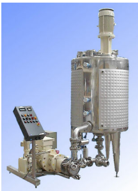
Rys. 7: Conti-TDS firmy ystral w instalacji do silnie zmiennych wielkości wsadowych
