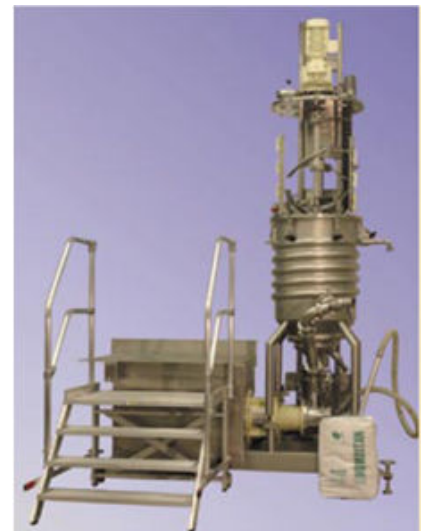
Instalacja z urządzeniem Conti-TDS do wytwarzania produktów o wysokiej lepkości.
