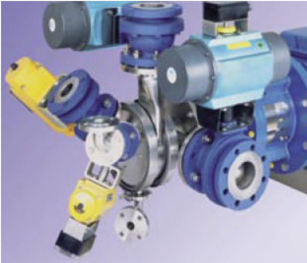
Głowica mieszająca Conti-TDS z wpustem i wylotem do cieczy oraz z wpustami do proszków.
